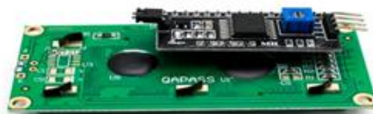
Рисунок 4.5 - 2x16 LCD дисплей з вбудованим I2C
