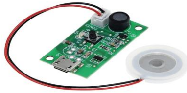
Рисунок 4.9 - Ультразвуковий зволожувач повітря
