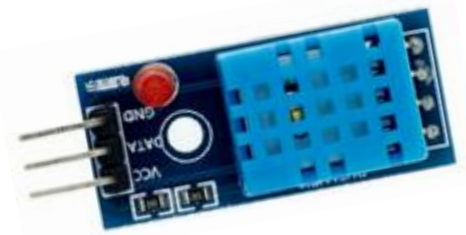
Рисунок 4.4 - Цифровий датчик температури та вологості DHT11
