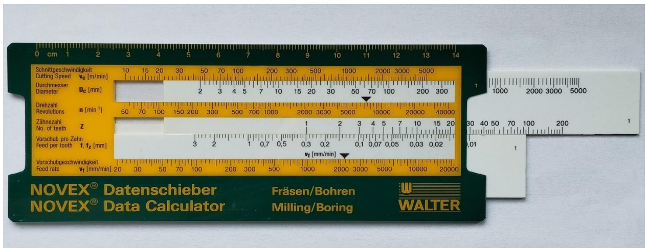
Рис. 1.10 – Знаходження режимів різання за калькулятором WALTER
