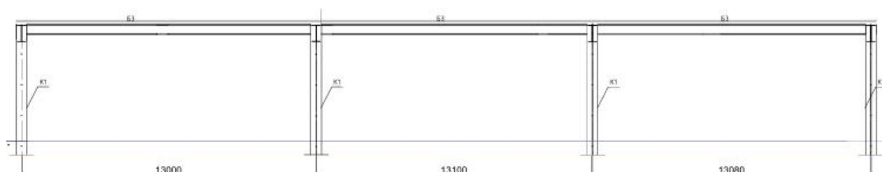
Рис.4.3. Поперечна рама будівлі
