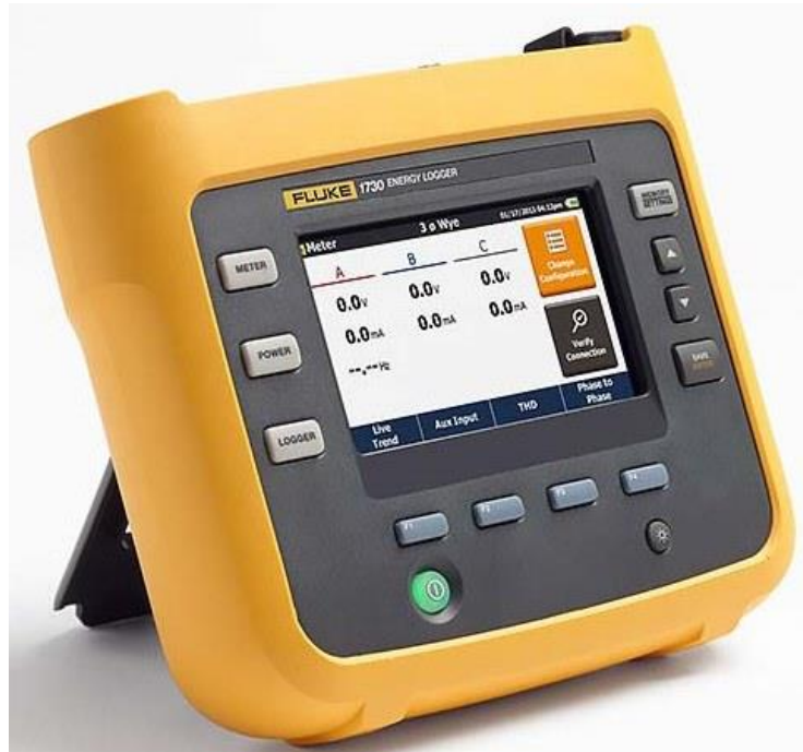
Рисунок 2.7 – Зображення Fluke 1730 для аналізу мережі [5]
