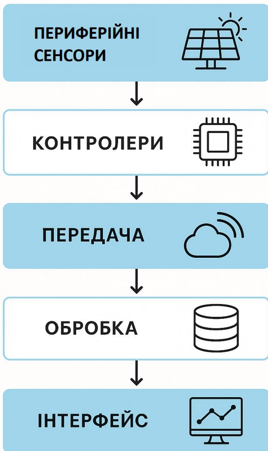
Рисунок 1.1 — Архітектура вимірювальної системи СЕС
