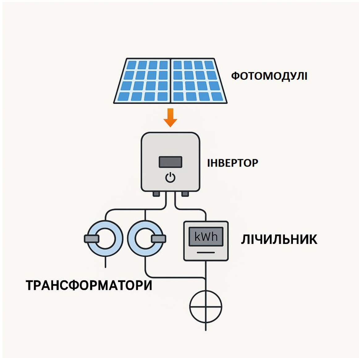
Рисунок 2.2 – Схема підключення трансформаторів і лічильника до інвертора
