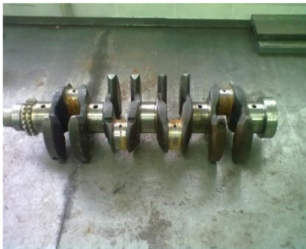
Рисунок 2 – Приклади відновлених і зміцнених ДАВ: а) палець поршня 304-10-2 (сталь 12ХН3А-42, HRC58); б) розподільчий вал 101410АО (сталь 45); в) колінчастий вал (сталь 18Х2Н4МА)
