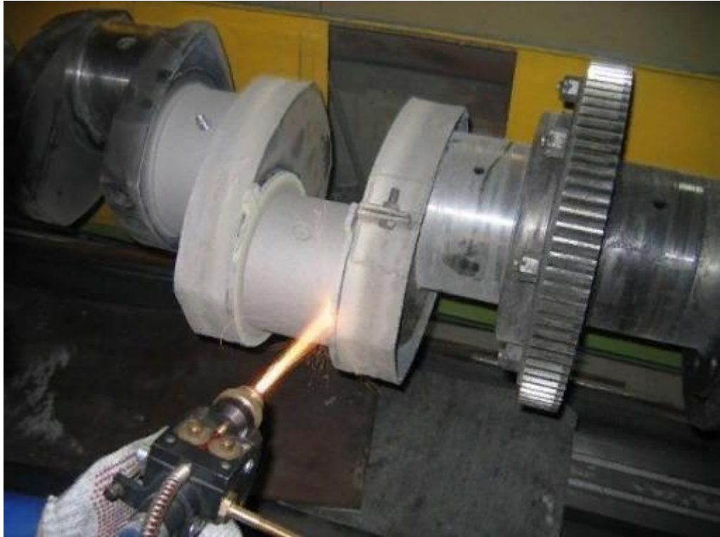
Рисунок 2.3 – Нанесення газоплазмового покриття
