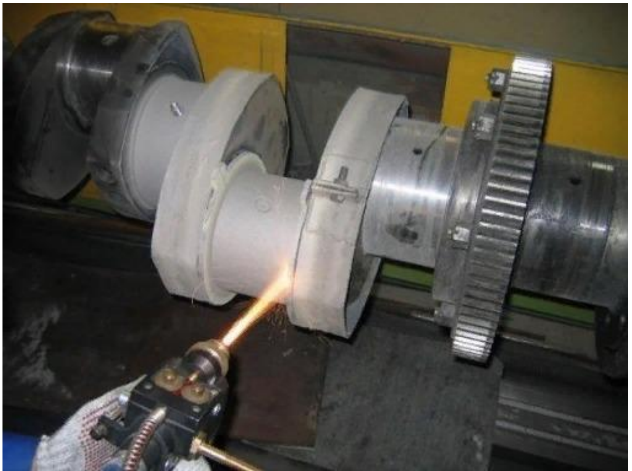
Рисунок 7 – Нанесення газоплазмового покриття
