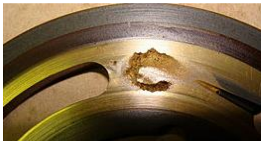
Рисунок 4.2 – Кавітаційне пошкодження пластини клапана аксіально-поршневого гідронасоса [9]
