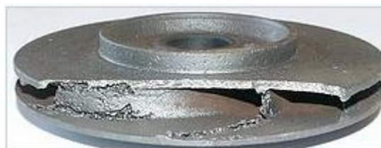
Рисунок 4.3 – Робоче колесо насоса, пошкоджене кавітаційною корозією [10]
