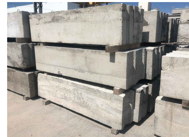
2 – Приклад складання фундаментних блоків
