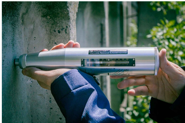
1 – Перевірка міцності бетону
