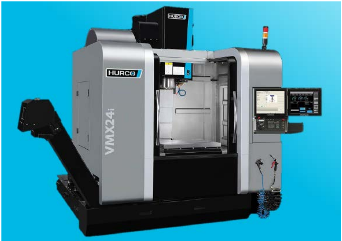
Рисунок 1.18 – Триосьовий оброблюючий центр HURCO VMX248
