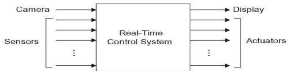
Рисунок 1.2 - Система керування в реальному часі, що включає вхідні дані від камери та кількох датчиків, а також виходи на дисплей та кілька виконавчих механізмів.
