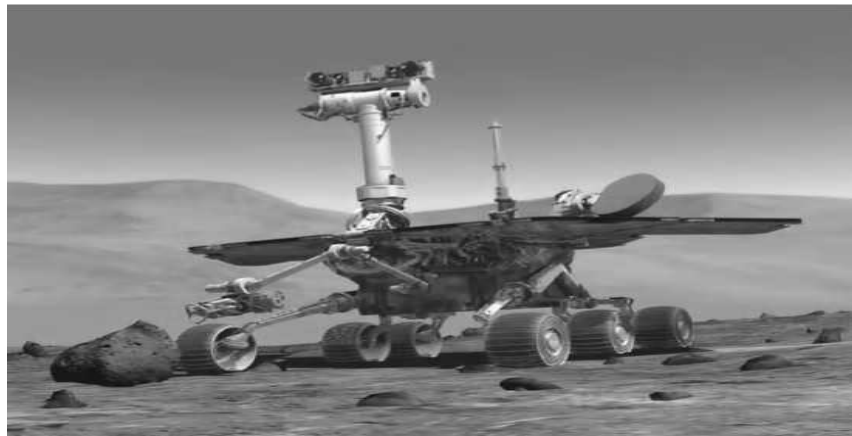
Рисунок 1.6 - Марсохід Mars Exploration Rover; автономна система реального часу на сонячній енергії з радіозв'язком та різноманітними датчиками й виконавчими механізмами. Фото надано NASA.
