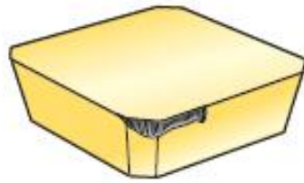
Рисунок 1.4 - Знос головної задньої поверхні ЗНБП токарного різця
