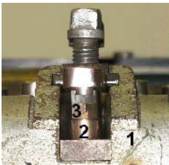
Рисунок 4.5 – Розміщення давачів АЕ на токарному різці: 1- різцетримач, 2 - широкосмуговий, 3- вбудований в різець
