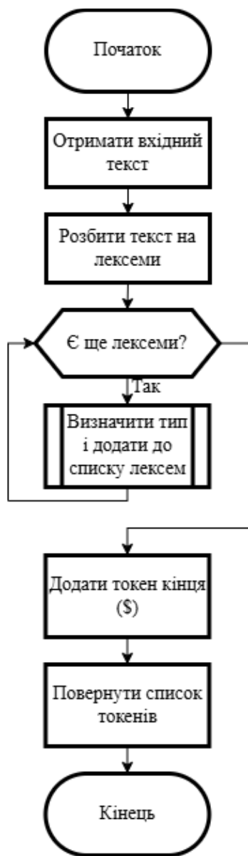
Рисунок 2.5 – Блок-схема алгоритму роботи лексичного аналізатора
