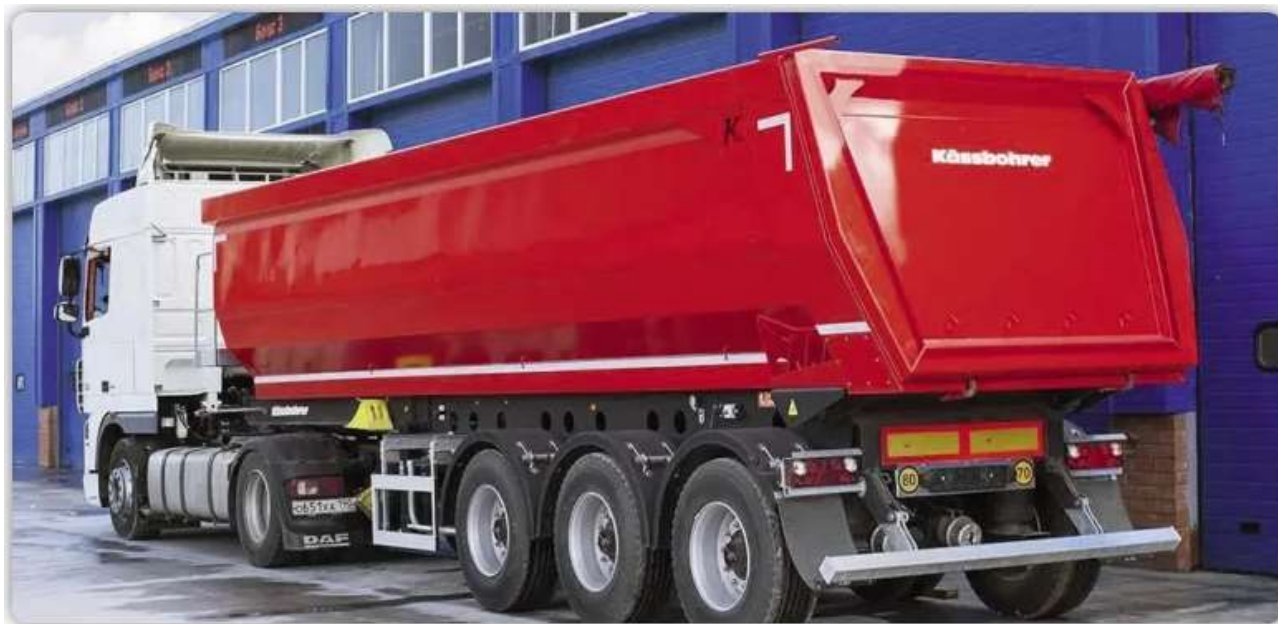
Рисунок 1.4 – Загальний вигляд автопотяга з напівпричепом-самоскидом Kässbohrer K.SKS.B: (повне розвантаження ще до досягнення граничного кута нахилу кузова 45°).
