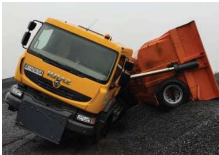
Рисунок 1.11 – Схиляння кузова та перекидання напівпричепа-самоскида внаслідок руйнування пневморесор
