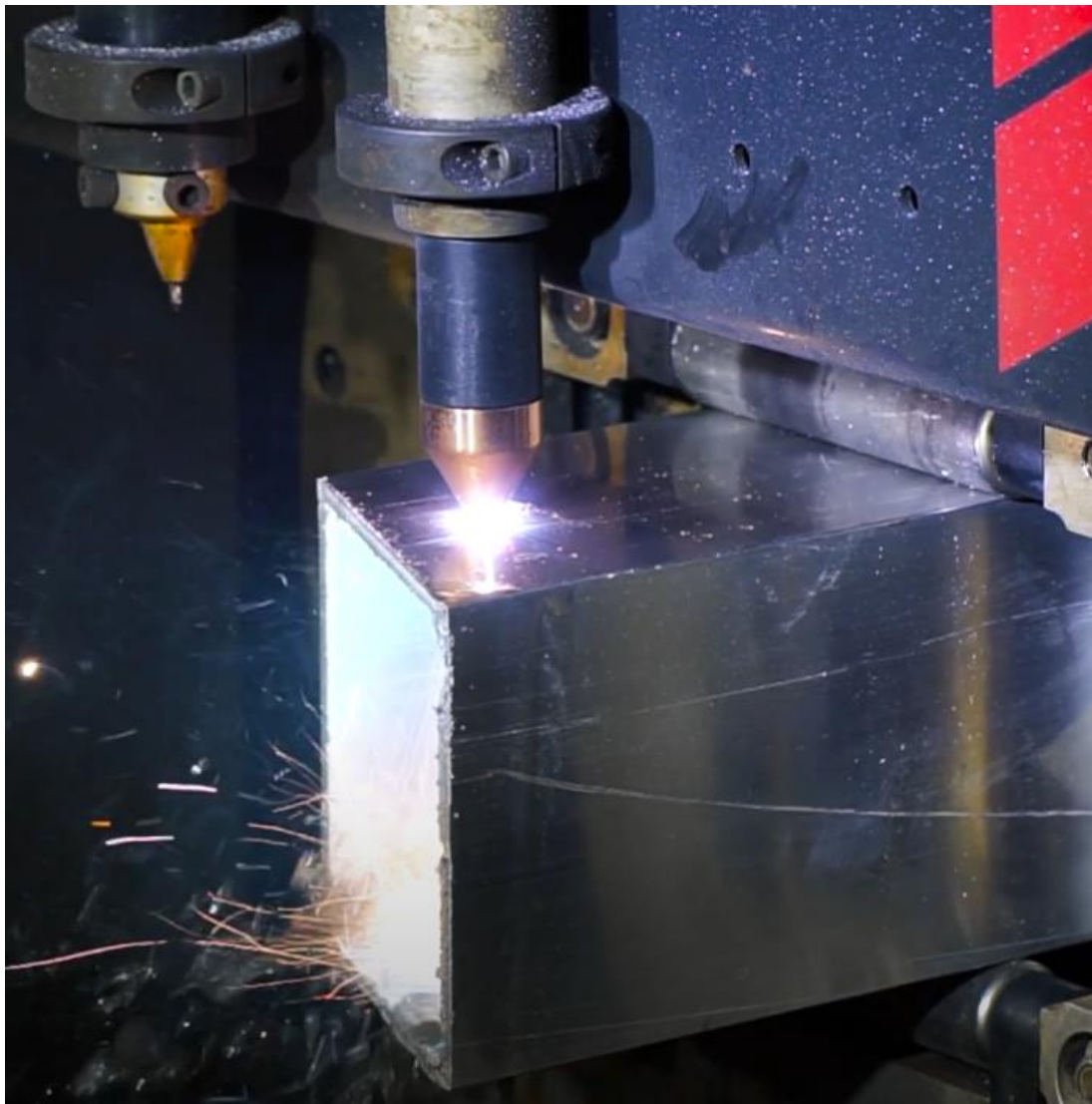
Рис 1.2.1 - приклад різання плазмою
