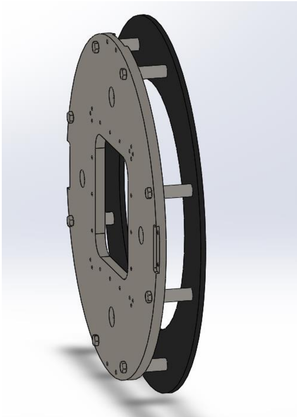
Рис 4.2.3 - Кріплення центральної деталі механізму до диску
