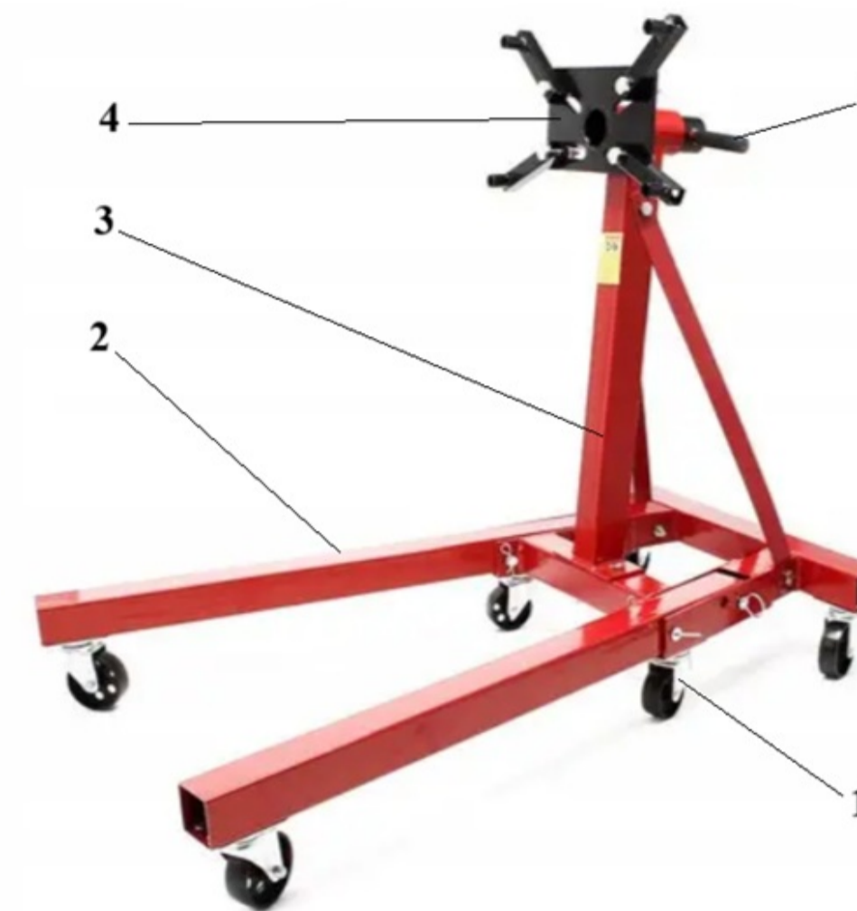
1 – основа стенду; 2 – стійка; 3 – платформа для закріплення агрегатів; 4 – ручка приводу редуктора; 5 – черв'ячний редуктор
