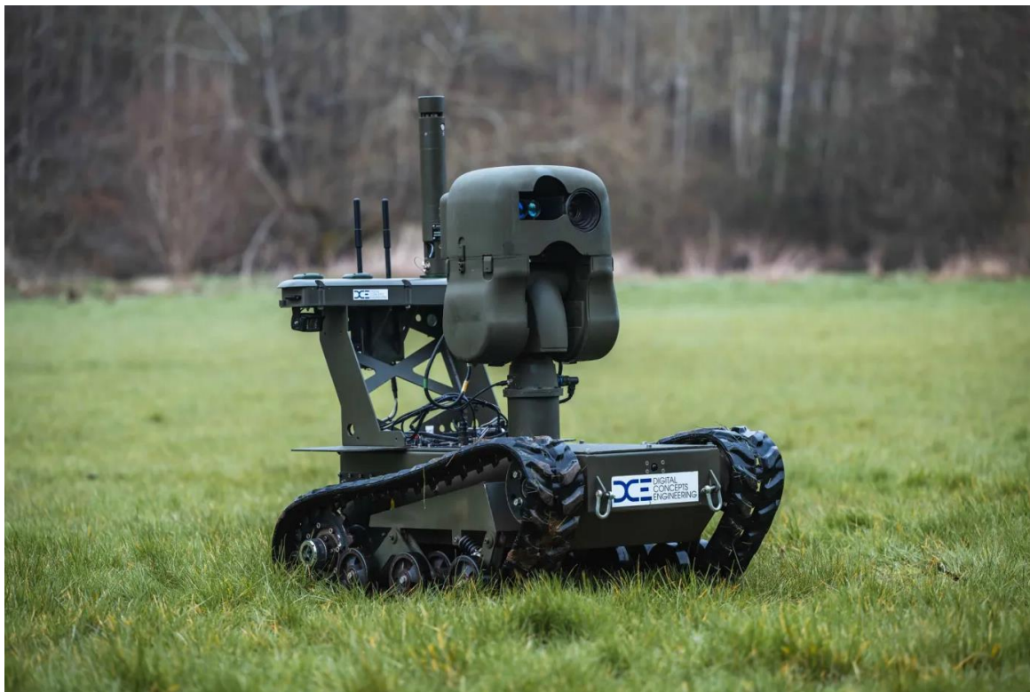
Рисунок 1.2 – Застосування гусеничної платформи на прикладі безпілотного наземного розвідувального робота X3 [5].
