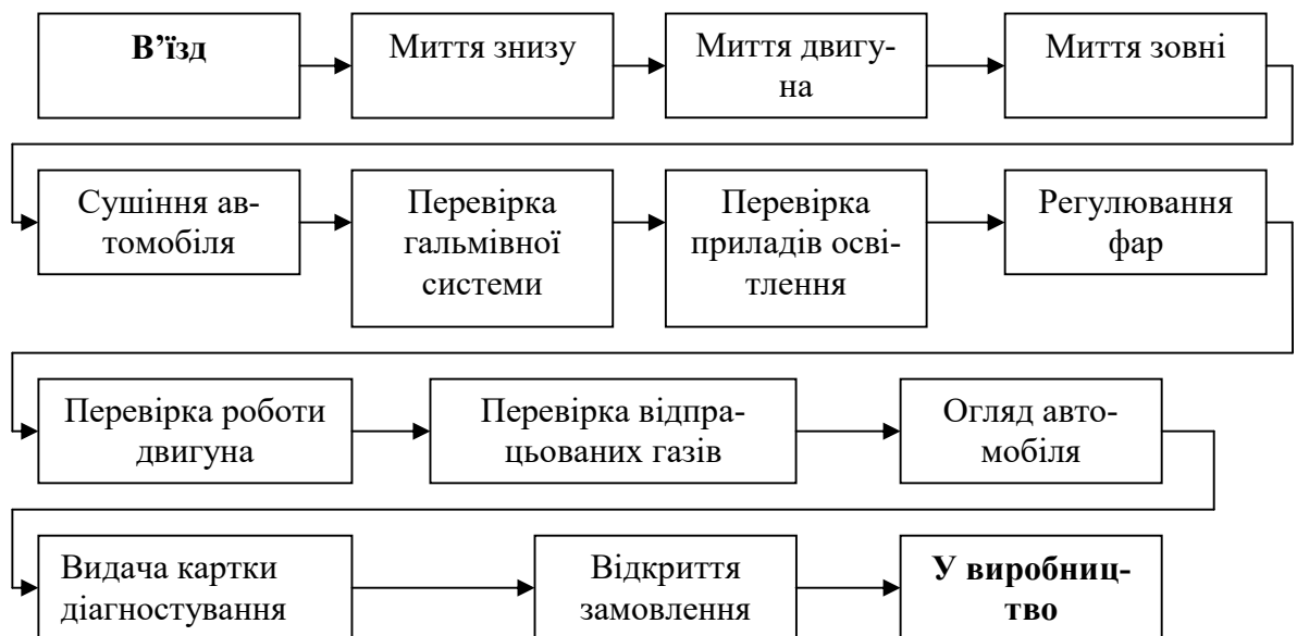
Рисунок 5.1 - Схема поточного технологічного процесу приймання автомобіля на ТО та ремонт СТО «СЕМ АВТО».
