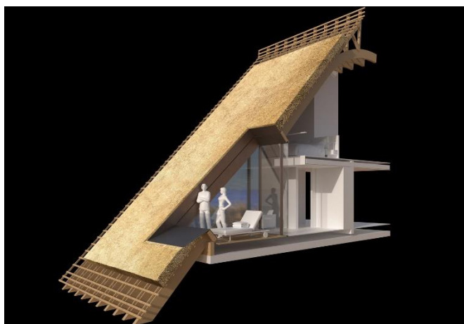
Рис. 3. Розріз конструкції даху
