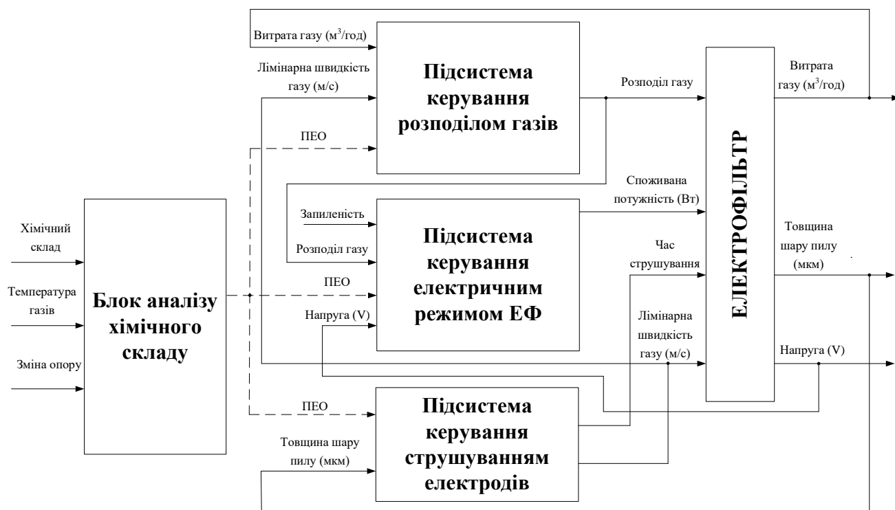
Рис. 1.5. Структурна схема установки очищення газу електрофільтрами
