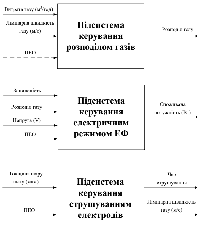
Рис. 1.4. Підсистеми керування очищення газу у електрофільтрі
