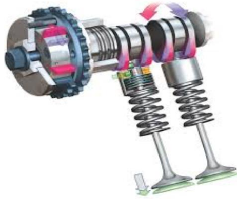
Рисунок 2.4 Принцип роботи розподільчого валу
