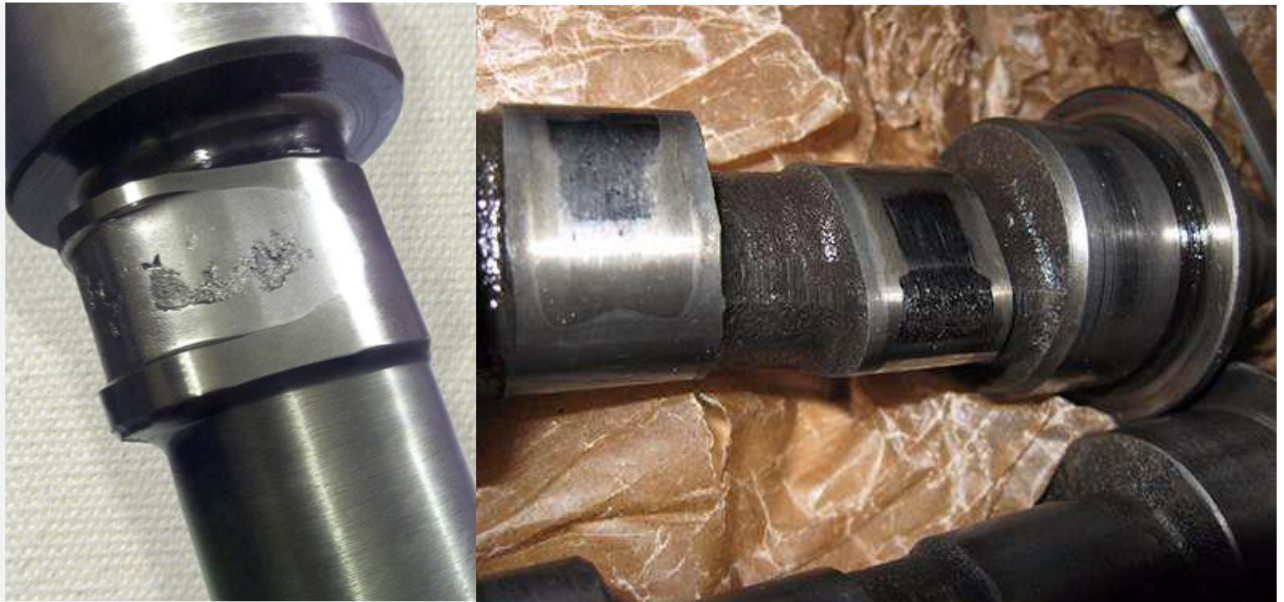
Рисунок 2.9 – Дефекти розподільчого вала
