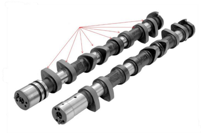
Рисунок 2.7. Відмінності в конструкції розподільчих валів, 1-впускний та 2-випускний.
