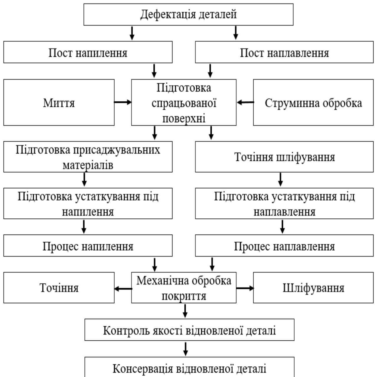
Рисунок 3.5 – Схема технологічного процесу відновлення деталей методами напilenня і наплавлення
