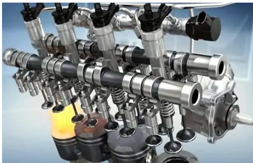
Рисунок 2.2 Газорозподільча система дизельного двигуна
