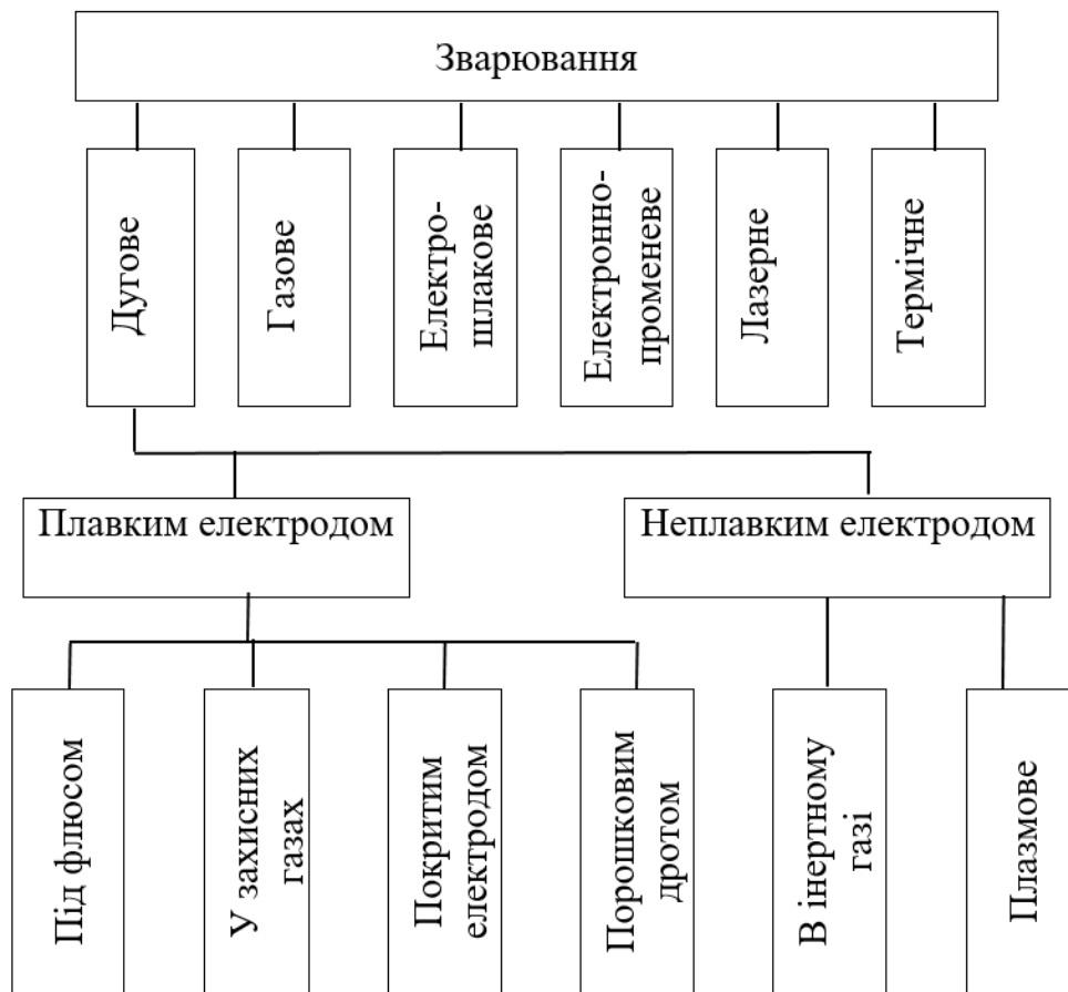
Рисунок 3.1 – Класифікація способів зварювання, які застосовуються у ремонтному виробництві.
