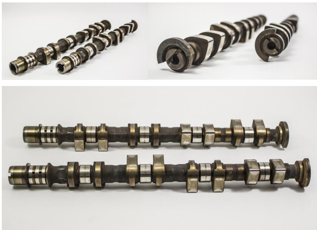
Рисунок 2.1 Загальний вигляд розподільчого вала
