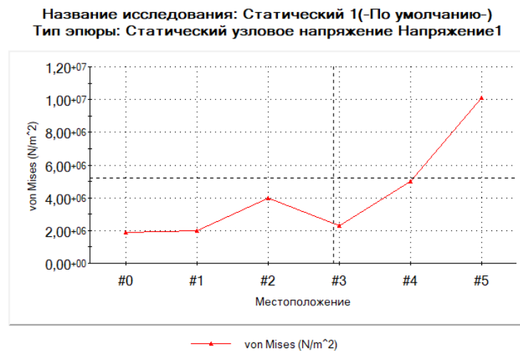
Рисунок 3.15 – Розподіл еквівалентних напружень по радіусу
