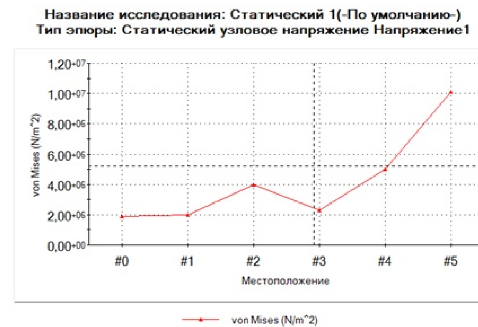
Рисунок 8 - Розподіл напружень по по радіусу
