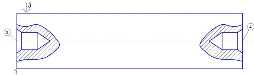
Рисунок 1. – Ескіз обробки деталі на 015 операції.
