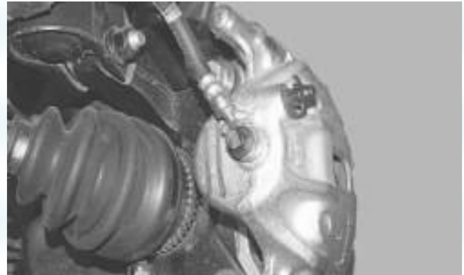
Рис. 7.4 – Заміна гальмівної трубки гальмівного супорта переднього колеса
