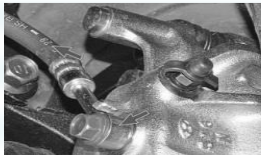
Рис. 8.4 – Прокачування гальмівного супорта переднього колеса
