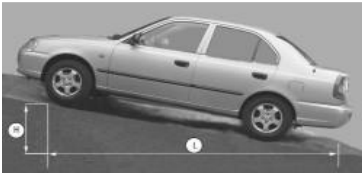
Рисунок 3.12 – Схема перевірки стоянкового гальма
