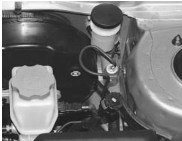
Рисунок 3.14 – Заміна гальмівних трубок головного гальмівного циліндра
