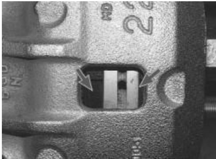
Рисунок 3.9 – Перевірка товщини фрикційних накладок гальмівних колодок через отвір в супорті
