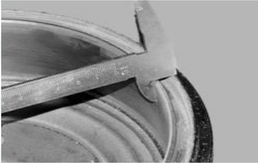
Рис. 7.1 – Вимірювання діаметра робочої поверхні заднього гальмівного барабана
