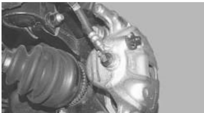
Рисунок 3.16 – Заміна гальмівної трубки гальмівного супорта переднього колеса
