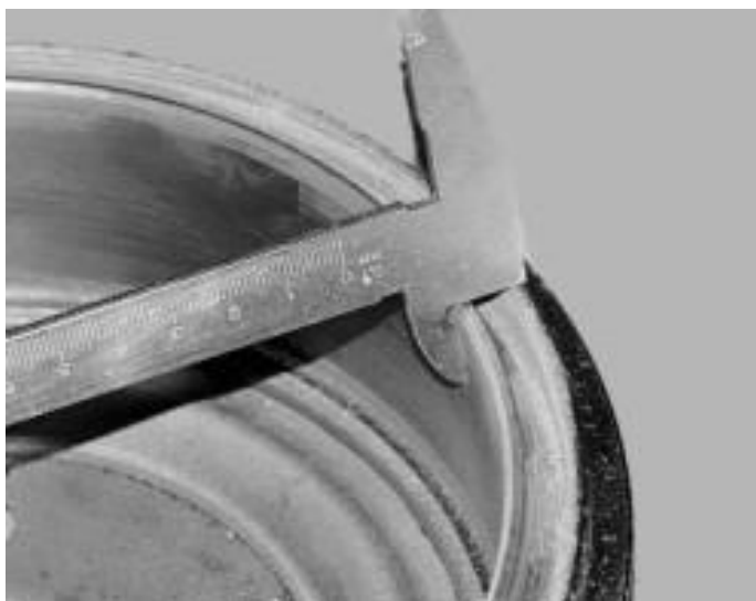
Рисунок 3.11 – Вимірювання діаметра робочої поверхні гальмівного барабана
