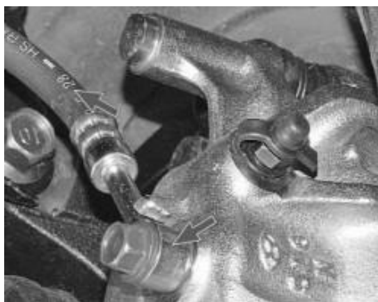
Рисунок 3.17 – З'єднання гальмівного шланга з гальмівним супортом
