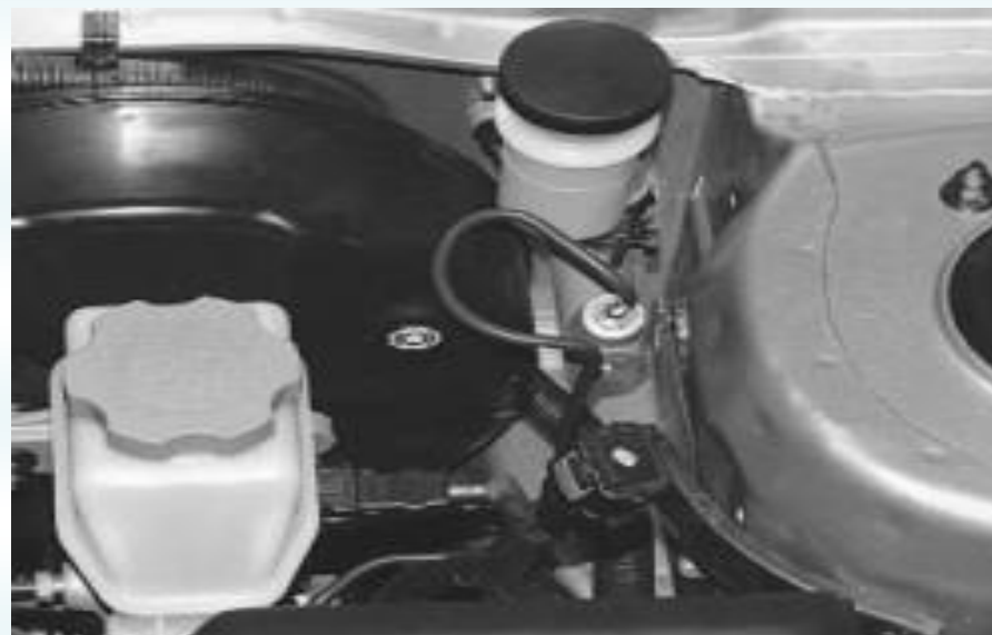
Рис. 8.2 – Заміна гальмівних трубок головного гальмівного циліндра
