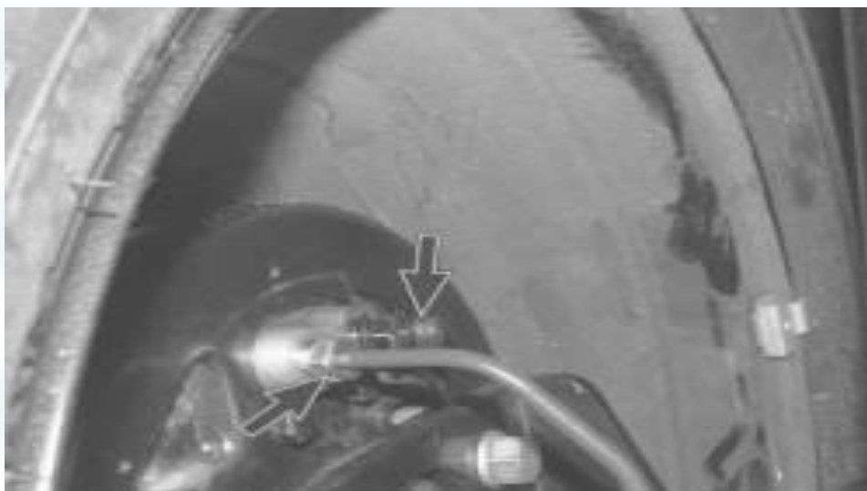
Рис. 8.3 – Заміна гальмівної трубки робочого гальмівного циліндра заднього колеса
