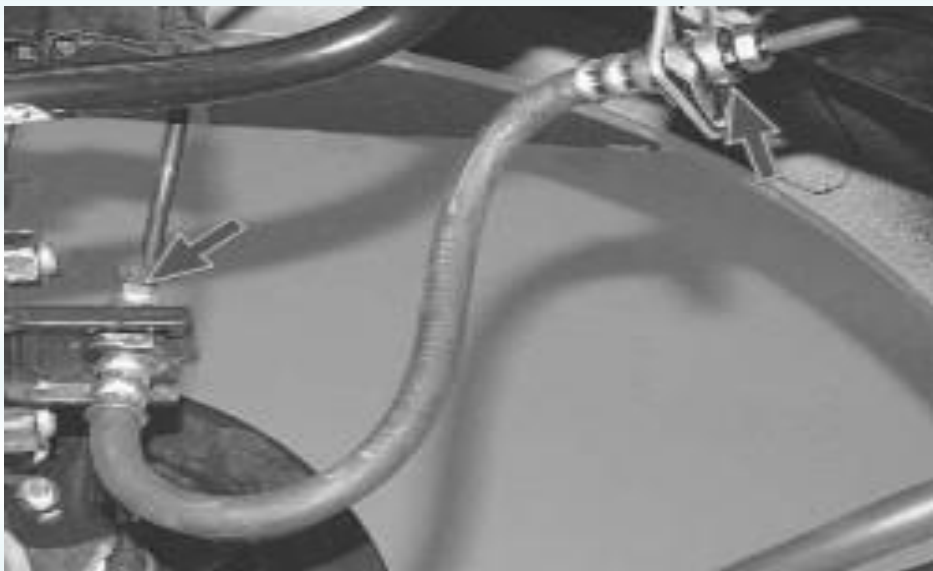
Рис. 8.1 – Заміна гальмівного шланга супорта переднього колеса
