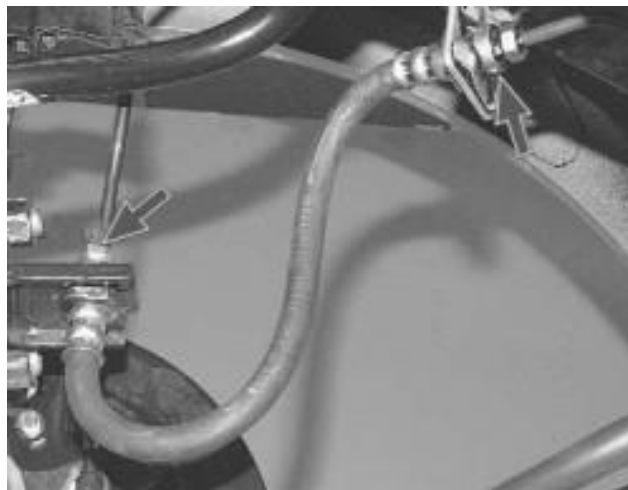
Рисунок 3.15 – Заміна гальмівного шланга супорта переднього колеса
