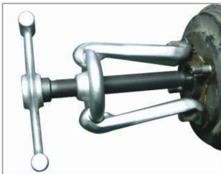
Рисунок 4.9 – Демонтаж гальмівного барабана
