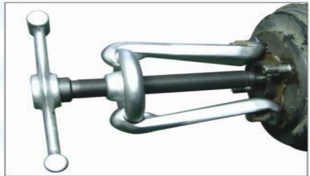
Рис. 10.2 – Демонтаж гальмівного барабана
