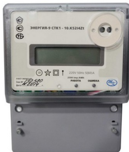
Рисунок 2.11 – Лічильник електроенергії СТК1-10К5Х14Zt
