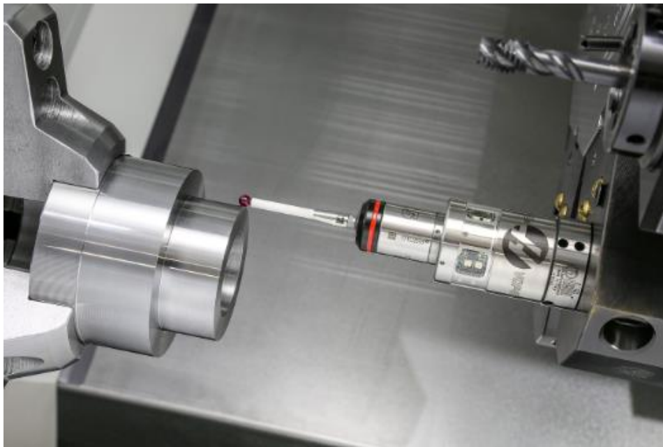
Рисунок 3.2 – Комплект безпроводного вимірного щупа WISP-L
