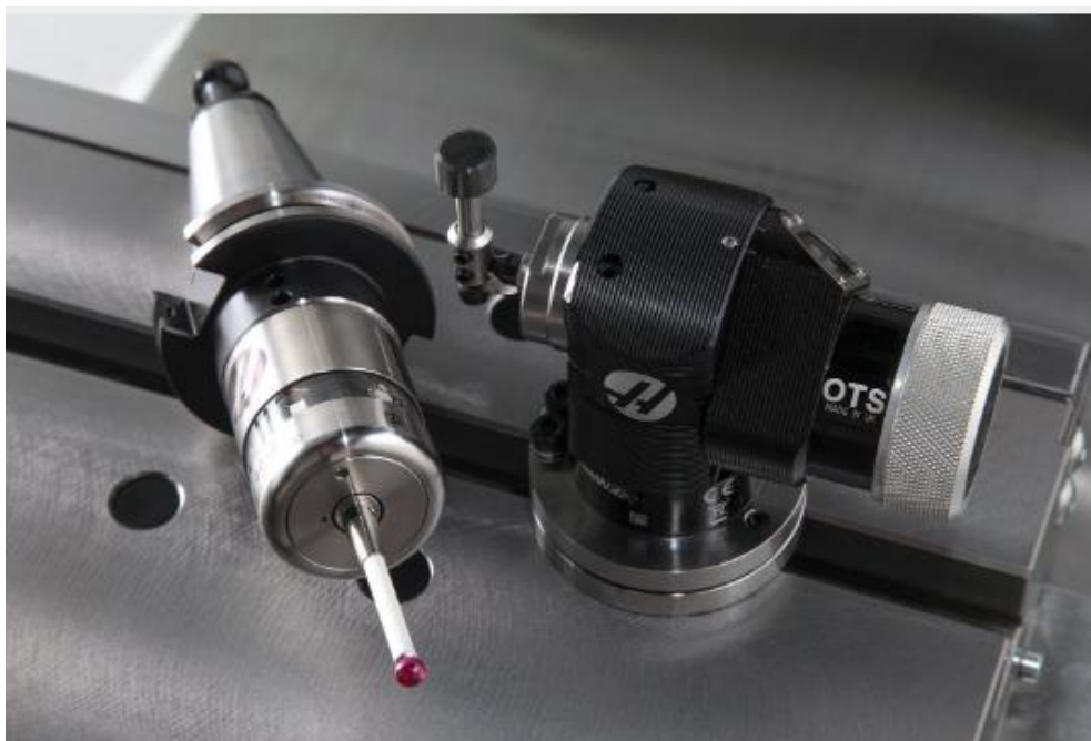
Рисунок 3.3 – Комплект безпроводного вимірного щупа WISP
