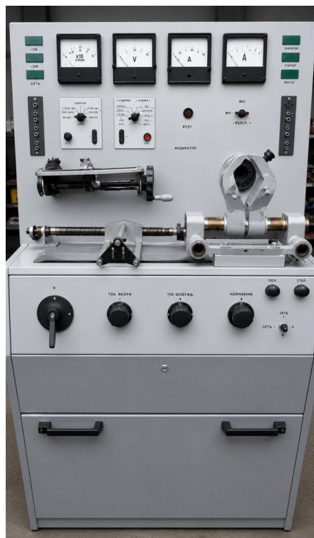
Рисунок 3.2 – Зовнішній вигляд стенду для перевірки генераторів моделі Е-211
