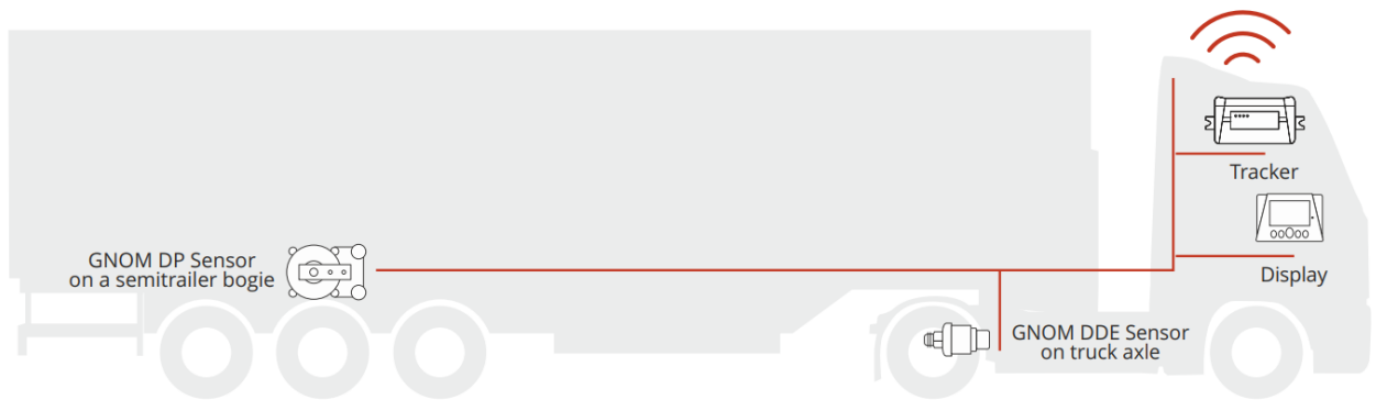
Рисунок 1.11– Приклад комплексної системи оцінки навантаження на осі із логуванням результатів в процесі експлуатації автомобіля
