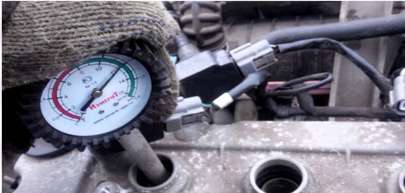
Рисунок 9.1 – Вимірювання рівня компресії за допомогою компресометра
