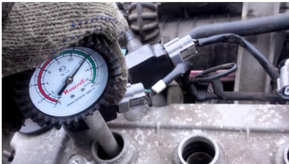
Рисунок 3.1 – Вимірювання рівня компресії за допомогою компресометра
