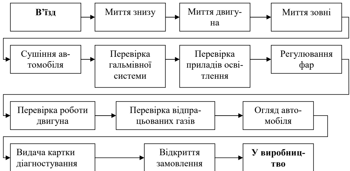
Рисунок 5.1 - Схема поточного технологічного процесу приймання автомобіля на ТО та ремонт СТОА Ауді
