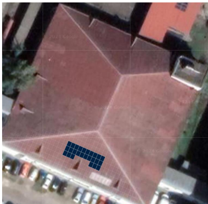
Рисунок 3.9 – Плоска проекція даху із розташованими фотомодулями
