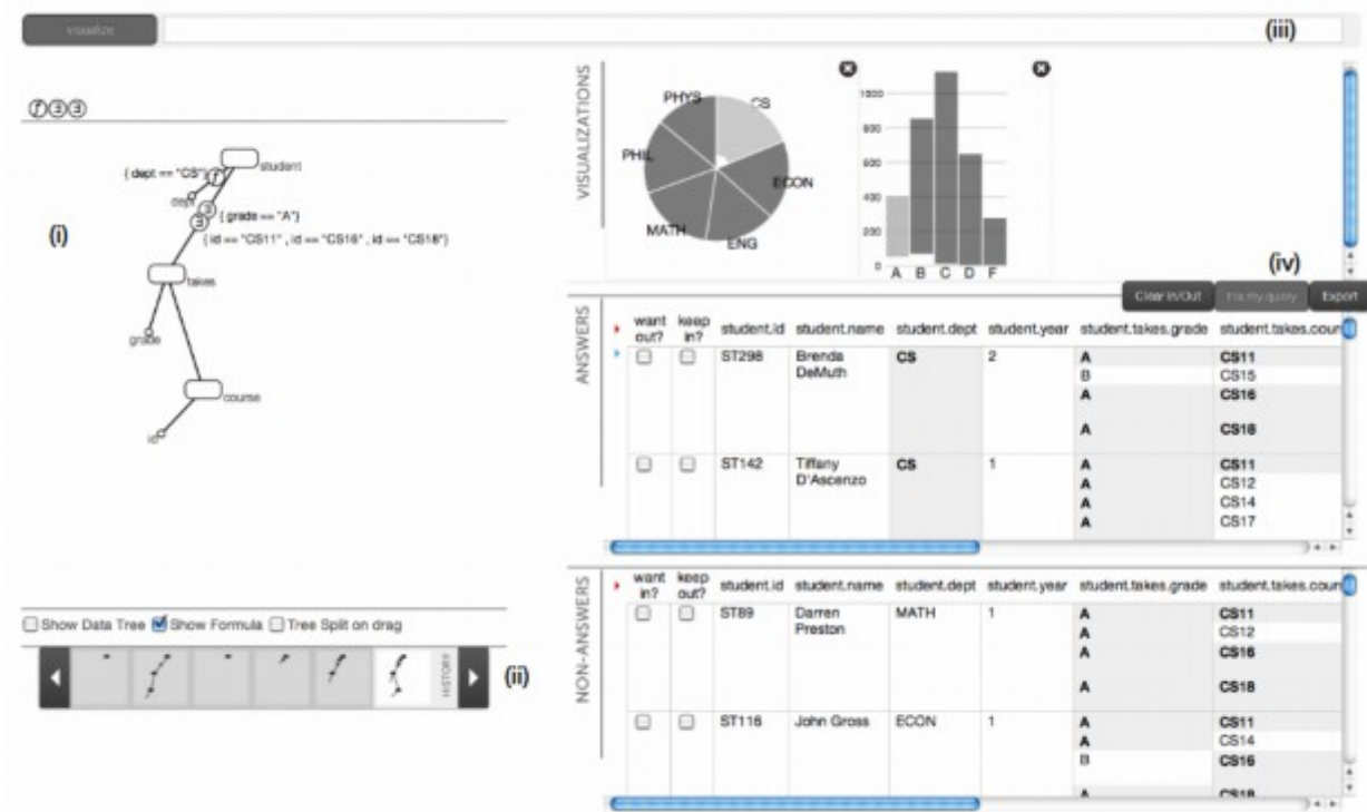
Рис. 2.7. Інтерфейс системи візуалізації запитів DataPlay: (i) дерево запитів (ii) інтерактивний графічний переглядач історії (iii) панель команд (iv) панель даних і візуалізації
