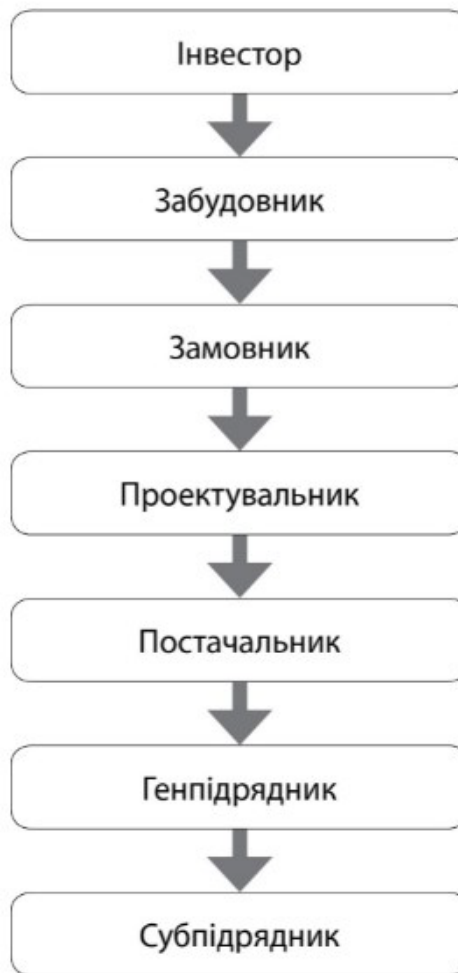
Рисунок 4.1 - Типова схема учасників будівельного процесу
