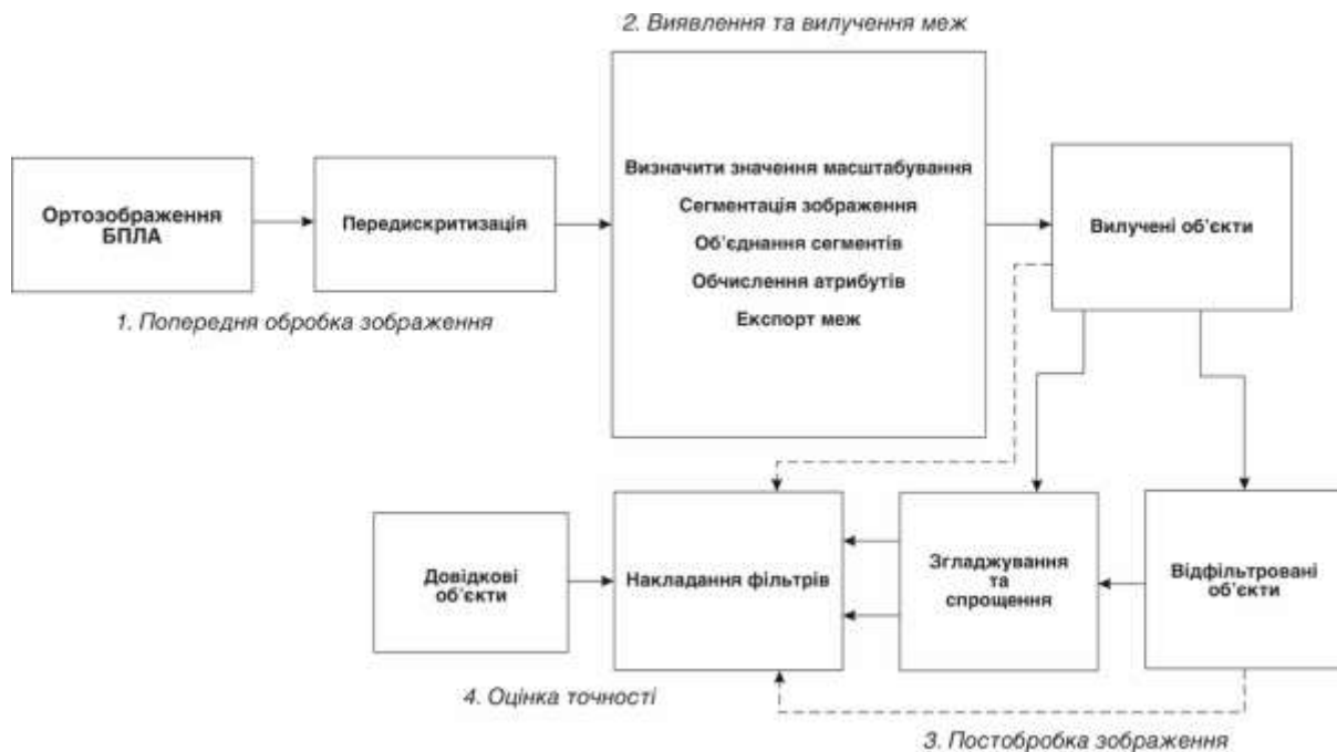
Рисунок 2.2 - Послідовність дій кадастрового картографування на основі автоматичного виявлення та вилучення видимих меж із зображень БПЛА
