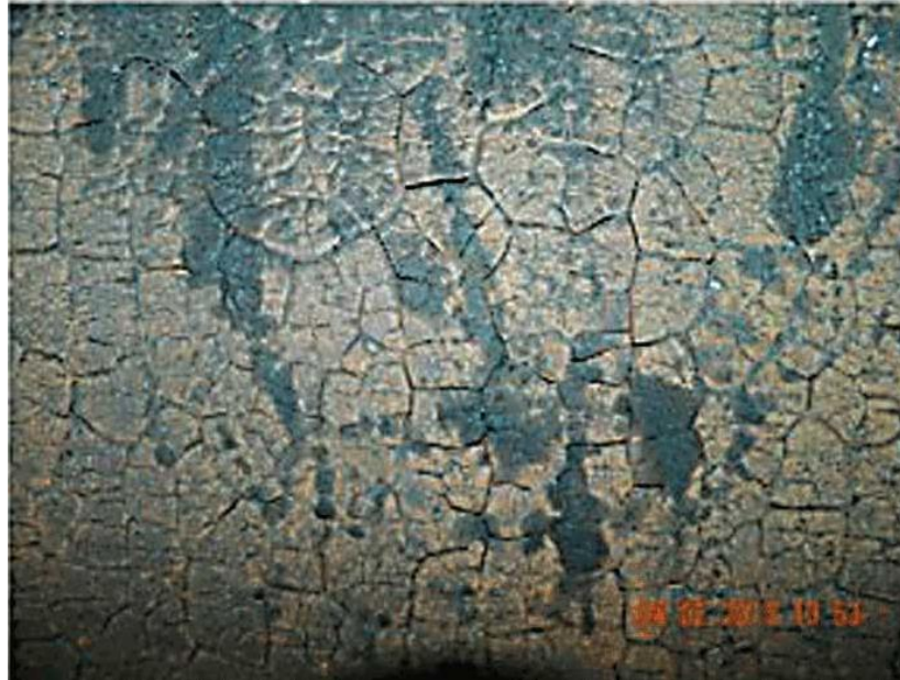
Рисунок 1.1 – Мережа термічних тріщин на поверхні валка прокатного стану
