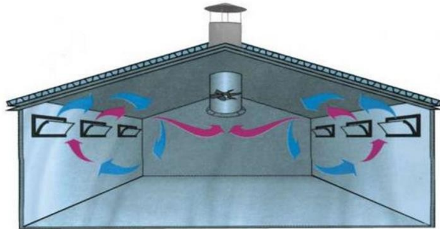
Рисунок 1.2 — Організована природна вентиляція
