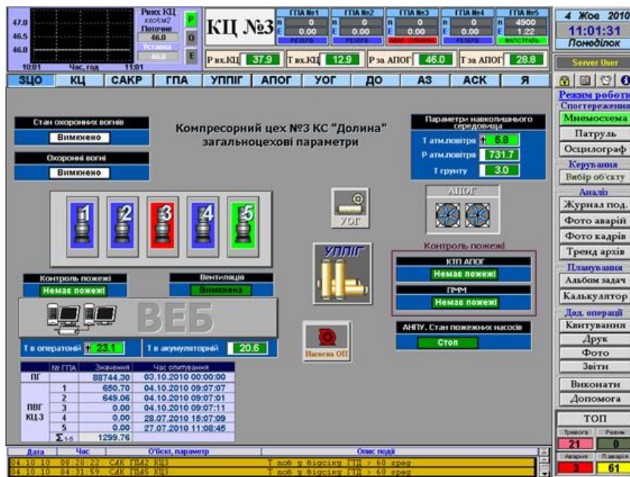
Рисунок 1.6 – Загальний вигляд вікна САУ компресорним цехом №3
