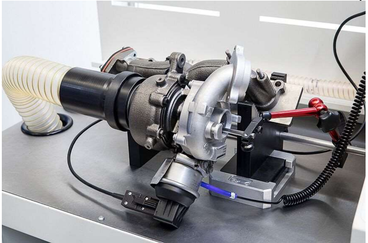
Рисунок 9 Турбокомпресор на стенді із зображенням основних його складових.
