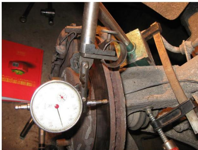
Рисунок 3.3. Вимірювання биття гальмівного диска
