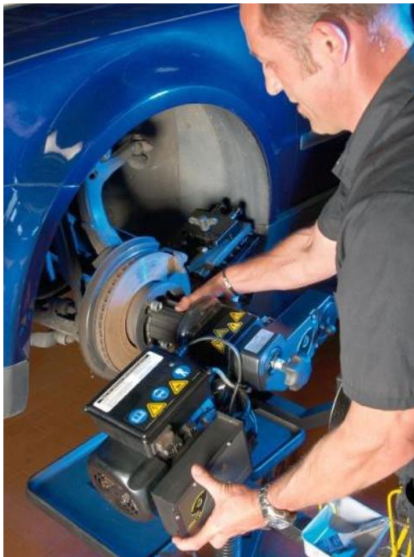
Рисунок 3.4. Прокатка дисків, встановлених на автомобілі.
