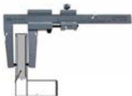
Методика вимірювання товщини гальмівного диска
