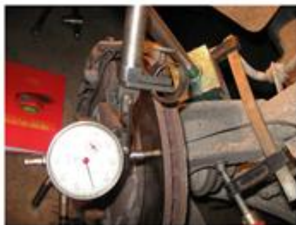
Вимірювання биття гальмівного диска
