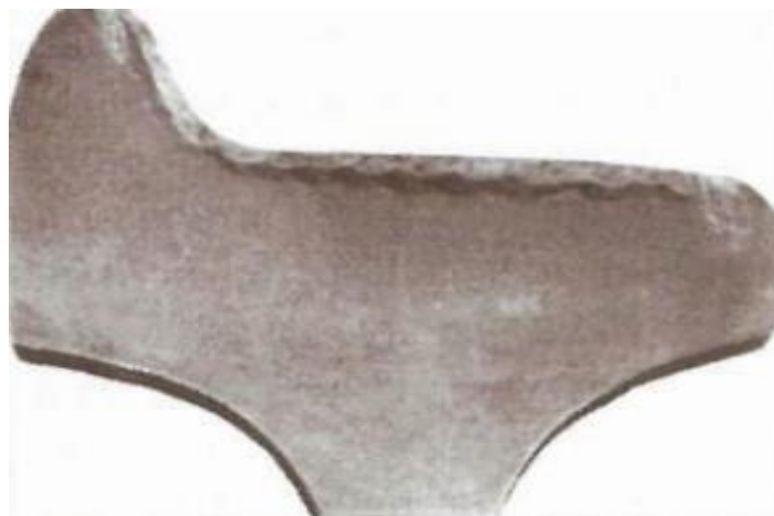
Рисунок 1.5 – Макроструктура наплавленої поверхні
