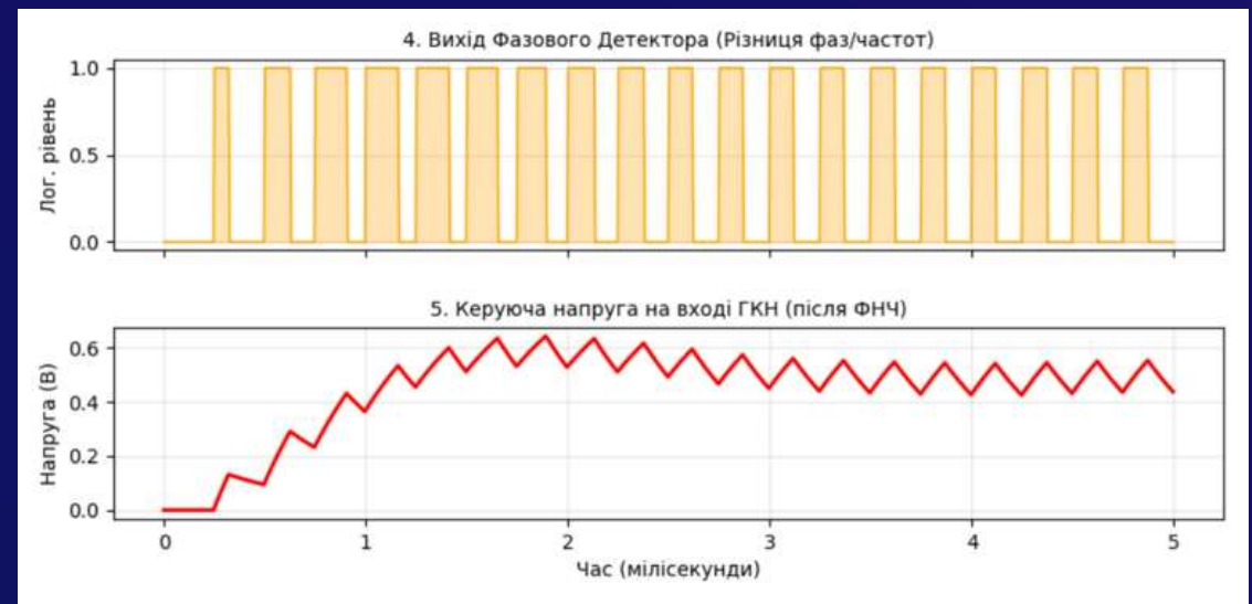
Рис. 7.2 – Симуляція роботи ФАПЧ (PLL) з дільником частоти (ч.2)
