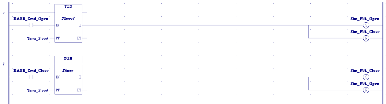
Рисунок 2.32 - Логіка імітації руху приводу з використанням таймерів та тригерних функцій (Set/Reset)
