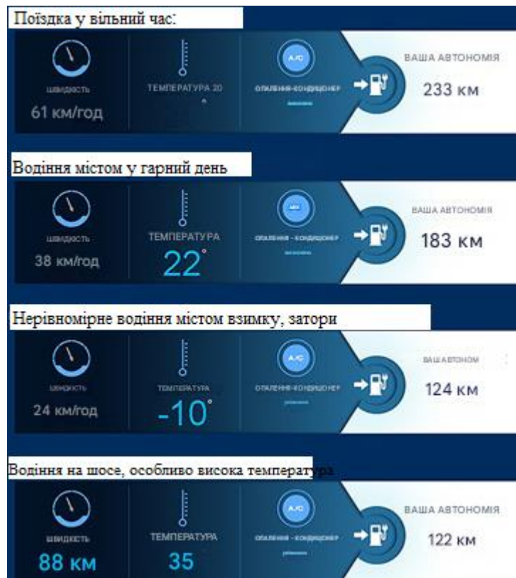
Рисунок 1.6 - Запас ходу електромобіля Nissan LEAF у різних режимах роботи [3]
