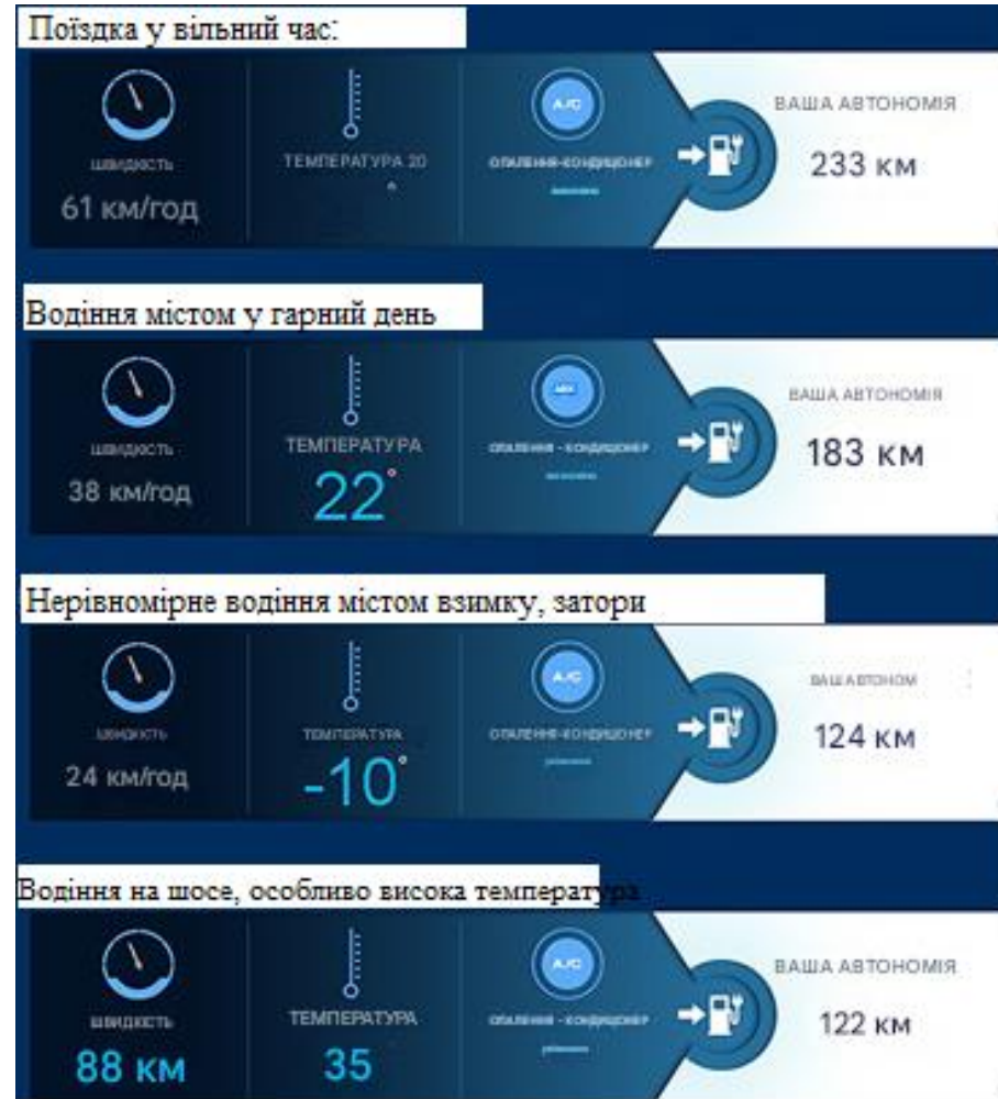
Рисунок 7 - Запас ходу електромобіля Nissan LEAF у різних режимах роботи [3]
