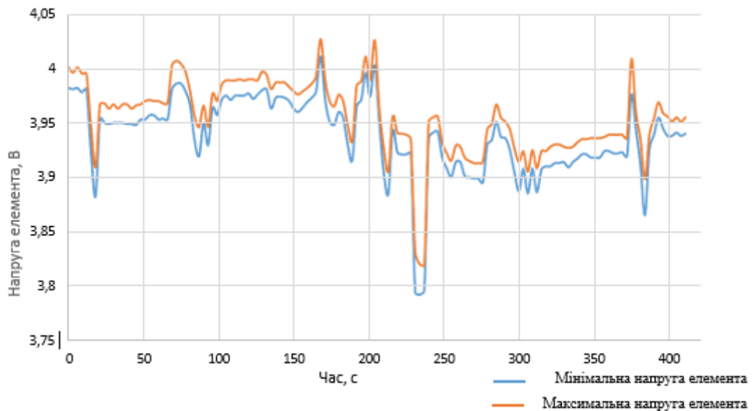
Рисунок 3.14 - Зміна заряду елементів акумулятора (кондиціонер та радіо увімкнені)
