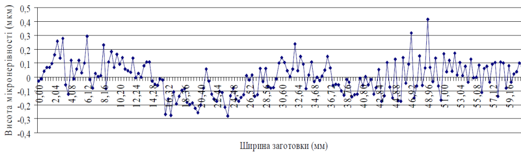
Рис. 14. Результати імітаційного моделювання утворення шорсткості оброблення плоскої поверхні зі сталі 40 (ділянка 0 – 60 мм) комбінованою торцевою фрезою ( V = 190 м/хв; S = 0,15 мм/об; t = 0,1 мм; P = 1000 Н)
