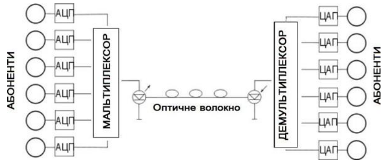
Рисунок 1.1 – Структурна схема ліній зв'язку.
