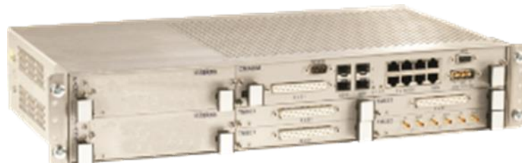
Рисунок 2.6 – Конструкція мультиплексора ADM-1/4 SDH
