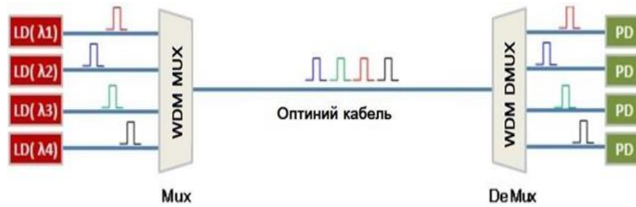
Рисунок 1.5 – Вигляд передачі Wavelength Division Multiplexing
