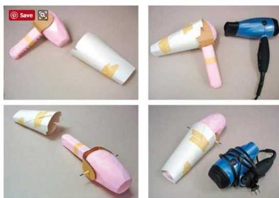
Рисунок 1.6 - Низькоточна фізична модель фена для волосся, виготовлена з пінопласту та паперу
