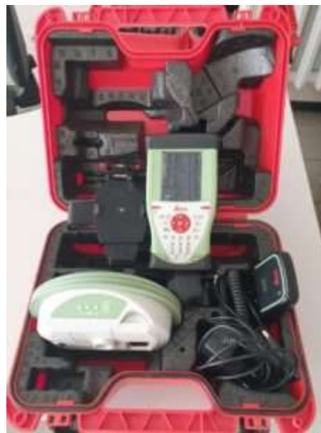
Рис. 2.1 Приклад GNSS-приймача Leica GS08plus
