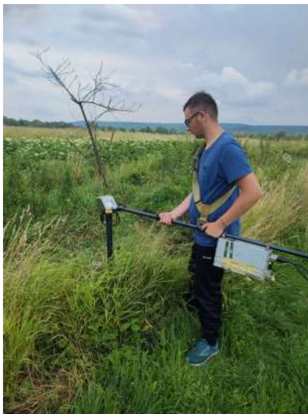
Рисунок 2.1 – Пошук ґрунтових реперів з допомогою металошукача-магнітометра
