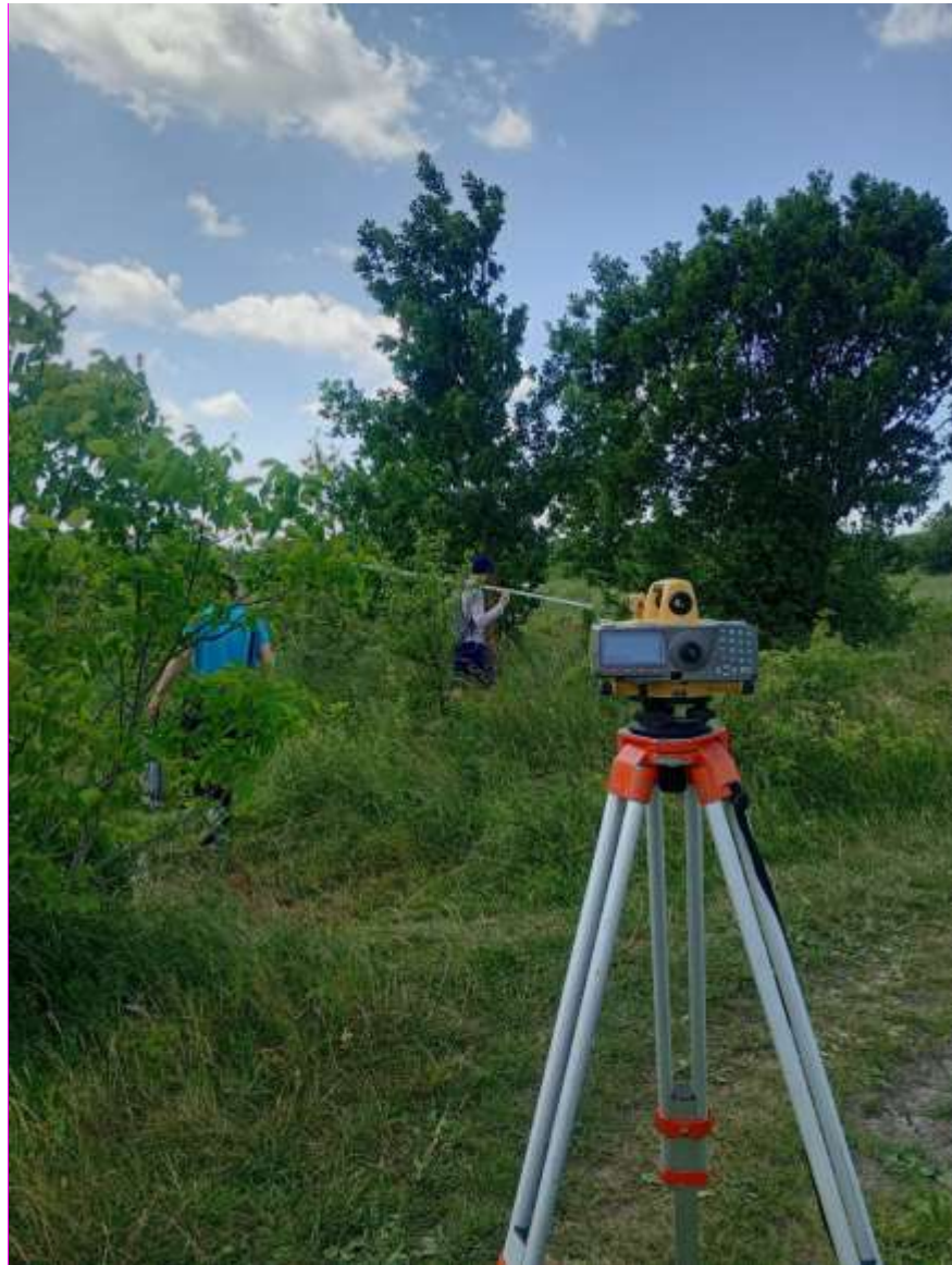
Рисунок 2.2 – Нівелювання в с. Кропивник електронним нівеліром TOPCON DL-501 та комплектом фібергласових штрихкодovих рейок
