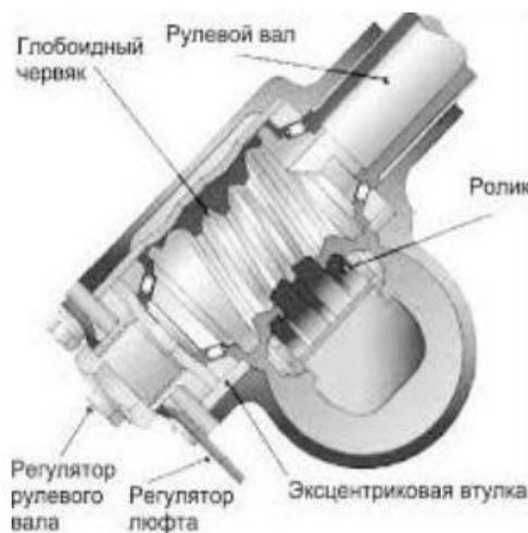
Рисунок 1.1. Конструкція черв'ячного рульового механізму
