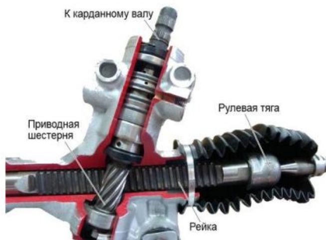
Рисунок 1.3. Конструкція рейкового механізму
