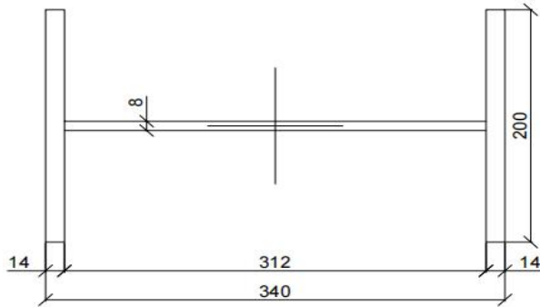
Рис. 4.3.3. Поперечний переріз колони
