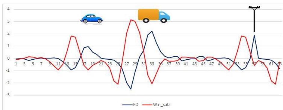
Рис. 3.13. Зміна показників магнітометра під час проходження повз автомобілі та електричні стовпи
