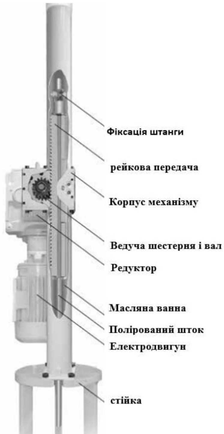
Рисунок 1.3 - Лінійний привід СШНУ на основі рейкової передачі, редуктора та реверсивного асинхронного електродвигуна
