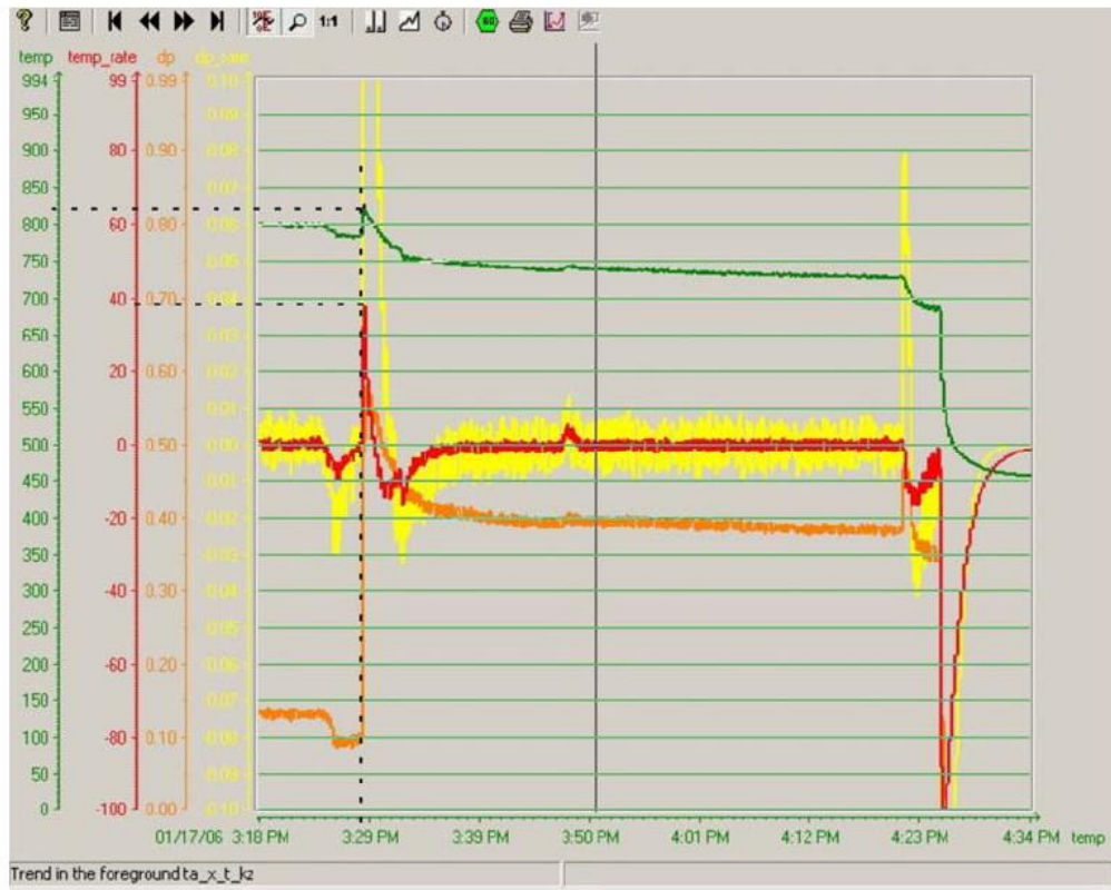
Рисунок 4.6 – Тренди SCADA системи під час зупинки ГПА
